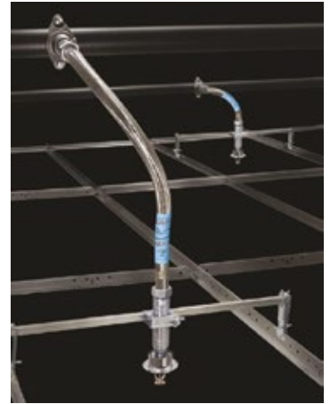
Şekil 3. Tavan yerleşme problemlerine karşı esnek düşüm ve açık-geçitli kelepçe çözümü
