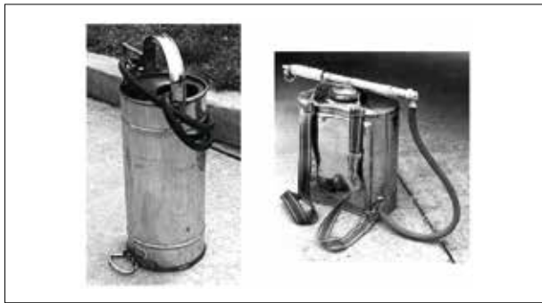
Şekil 1.2. Pompalı depolu sulu söndürme cihazları
